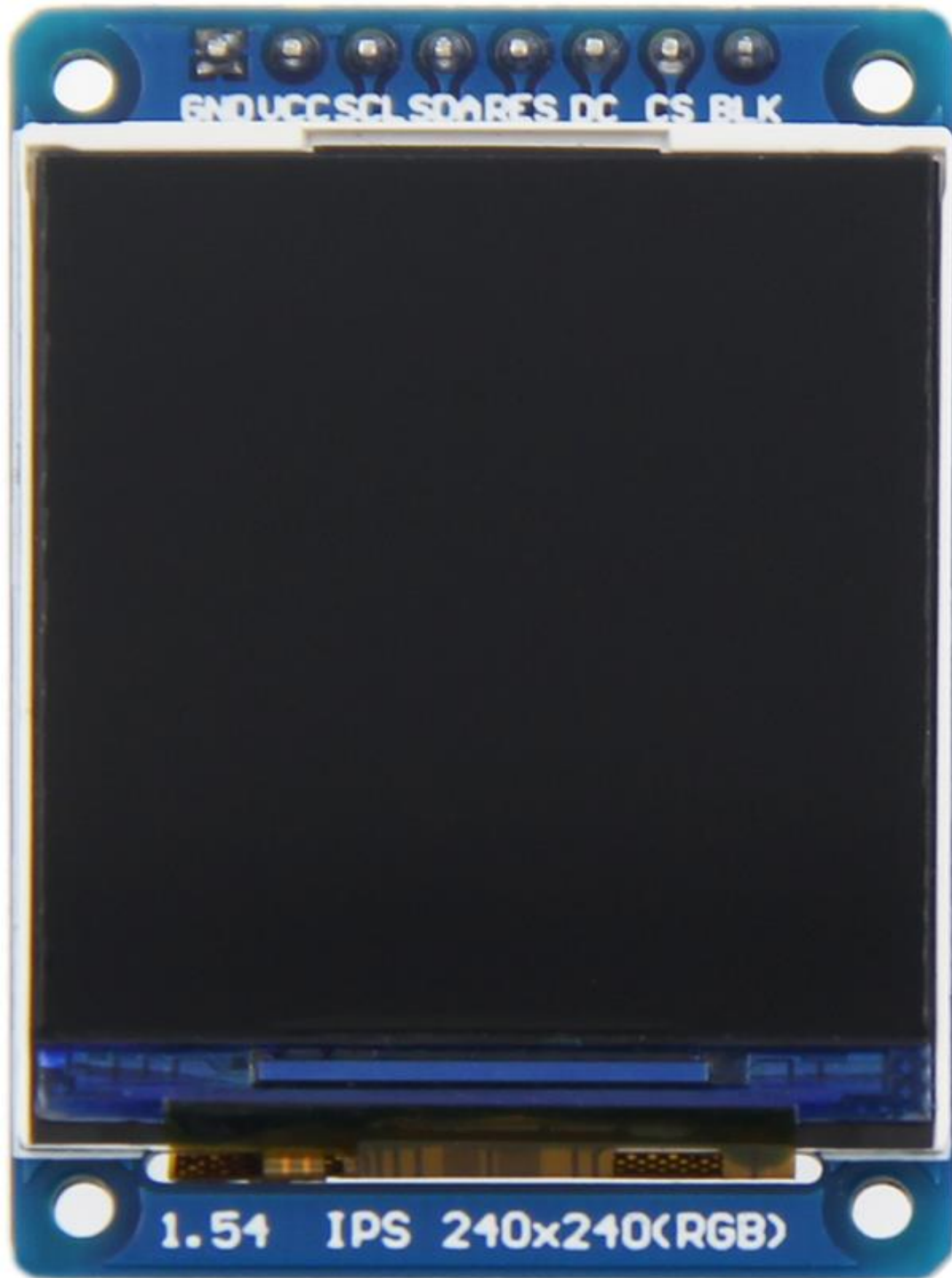
图1. 模块引脚丝印图
