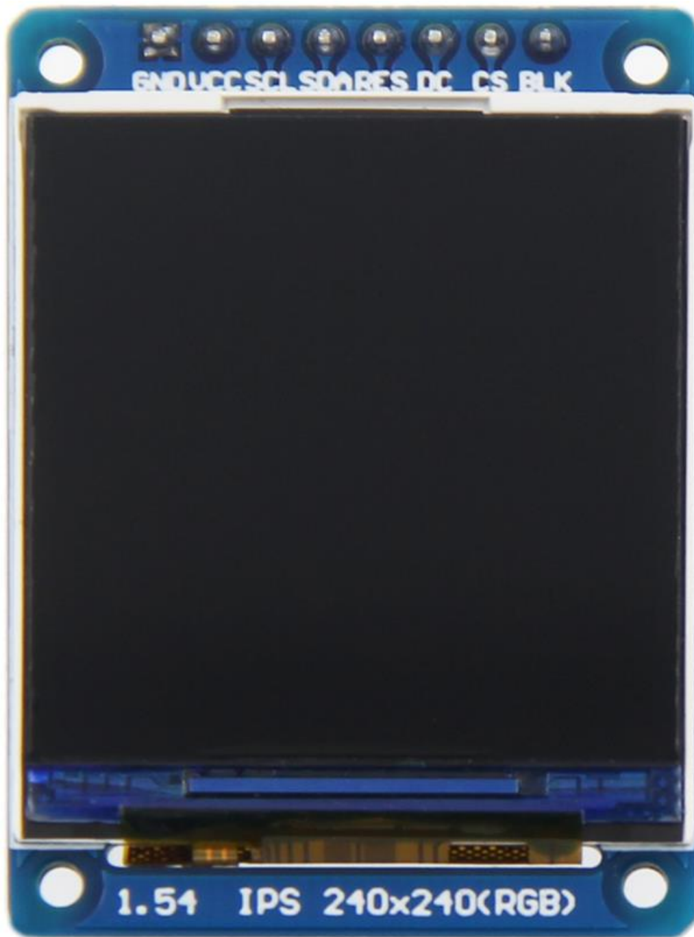
图1. 模块引脚丝印图
